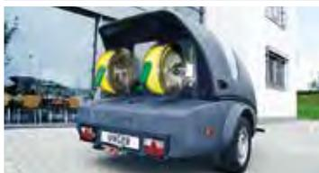
Adapté aux véhicules avec une charge de remorque allant jusqu'à 1 500 kg. Réservoir grand volume, intégré dans un châssis léger pour manœuvrer en toute sécurité. Homologation du TÜV, un essieu, freins intégrés, éclairage et clignotants. Livraison avec système d'attelage européen standard, roue de support, frein à main, ainsi qu'une béquille pour une meilleure stabilité. Conformité UE.
